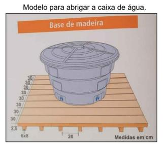
Utilizar caixa de água para reservatório diário e distribuição interna nos pontos de utilização.
