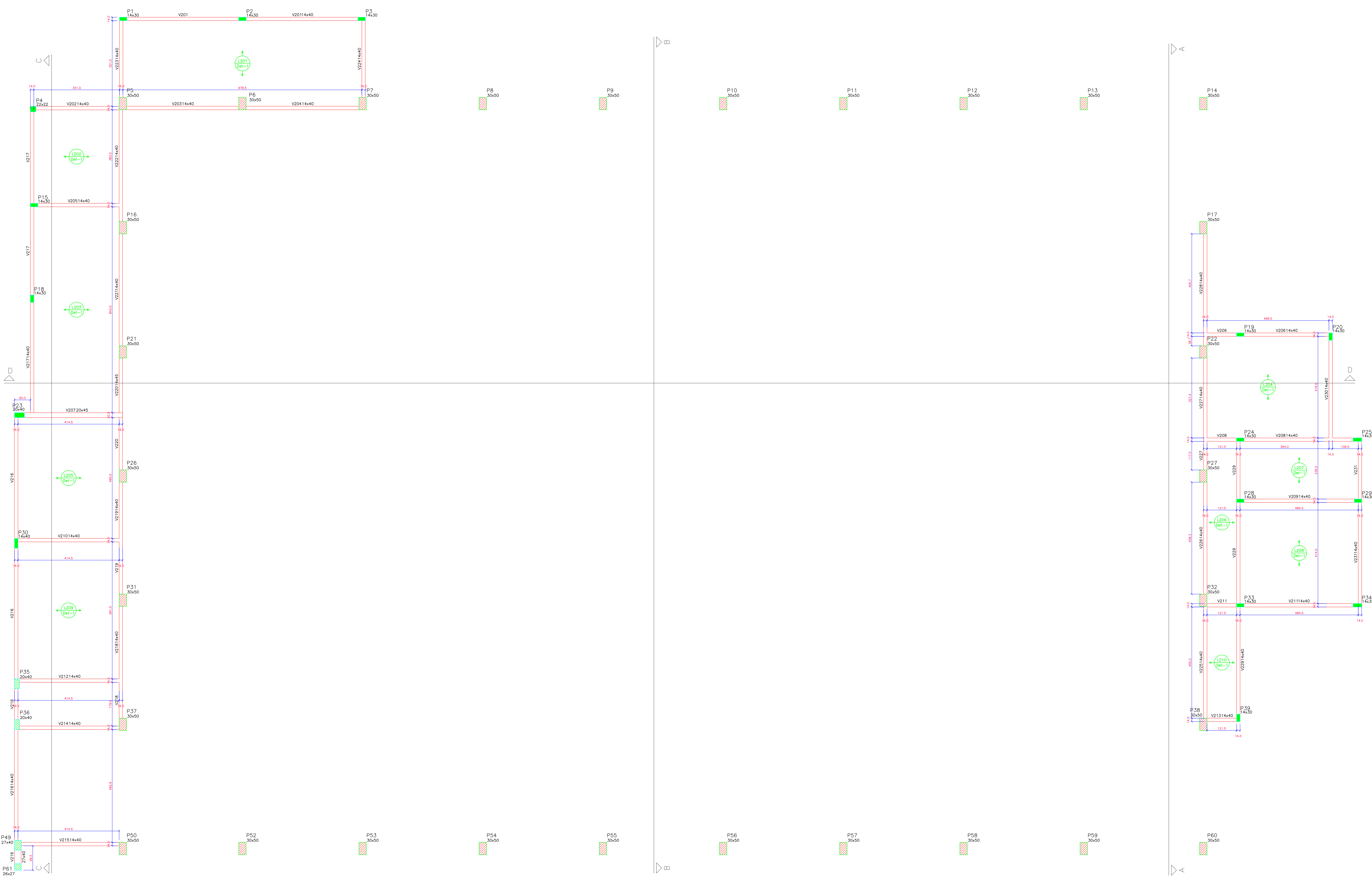
FORMAS LAJE DE COBERTURA (NÍVEL 300) ESCALA: 1/50
