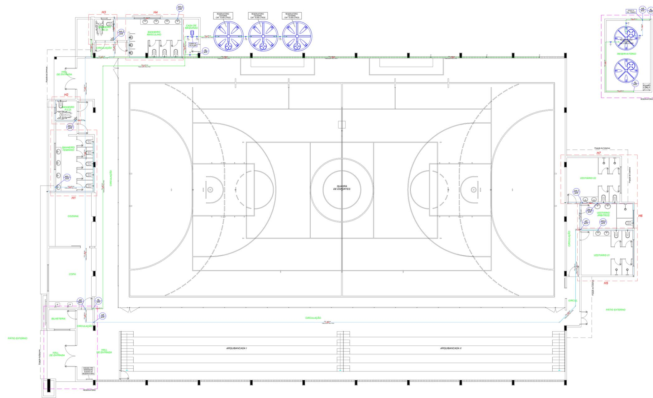
**INSTALAÇÃO HIDRÁULICA - ÁGUA DE REÚSO E CISTERNA**
